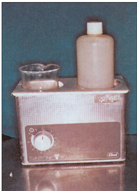
Εικ. 8.1: Τοποθέτηση του μεταλλικού σκελετού σε πλαστικό δοχείο που περιέχει υδροφθορικό οξύ και βύθιση του δοχείου σε λουτρό με υπερήχους.
