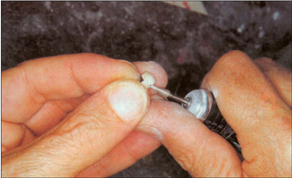
Εικ. 8.26: Με διαμάντι τροχίζουμε τη στεφάνη.
